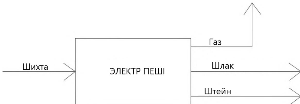
2.1-сурет – Алты электродты руднотермиялық электр пеші басқару жүйесі
